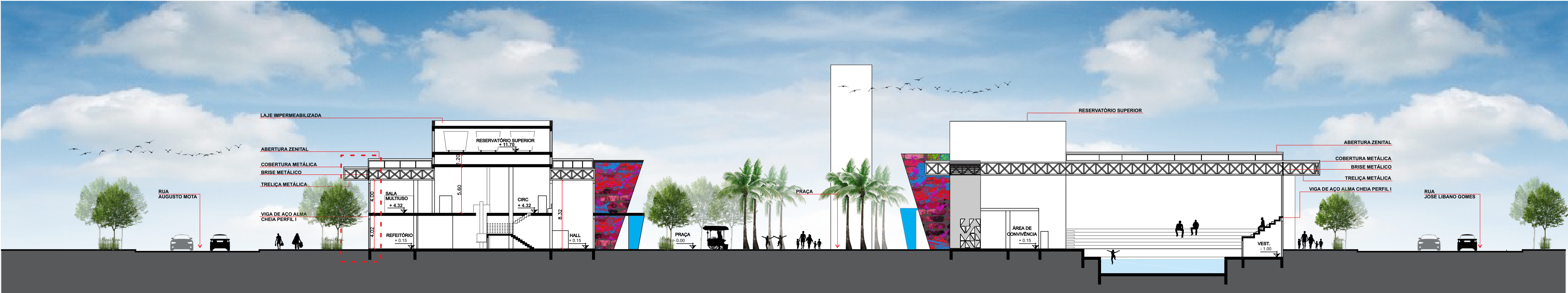
CORTE AA esc: 1/250 No corte A é possível visualizar o grande eixo central da praça marcado pelas palmeiras, servindo como elemento estruturador dos caminhos. O corte evidencia o desnível criado na área esportiva da edificação, fazendo com que o observador chegue em nível superior aos praticantes. No setor administrativo, é notável o pé direito duplo na entrada do mesmo. A estrutura metálica é representada com maior requinte no detalhamento 01
